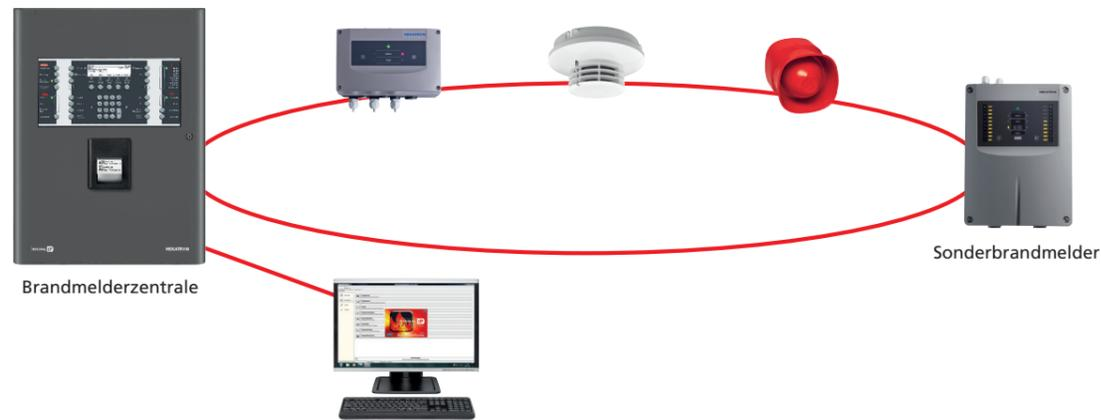
Der Datenaustausch zwischen den Sonderbrandmeldern und der Brandmelderzentrale erfolgt über die bestehende Ringleitung der Integral IP in beide Richtungen. Für den Zugriff auf die Melder sind somit keine zusätzlichen Kabelinstallationen nötig.
